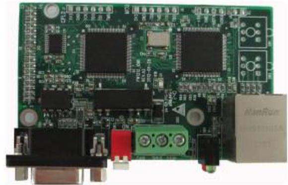
图 B-3 Ethernet+PROFINET 通讯卡
