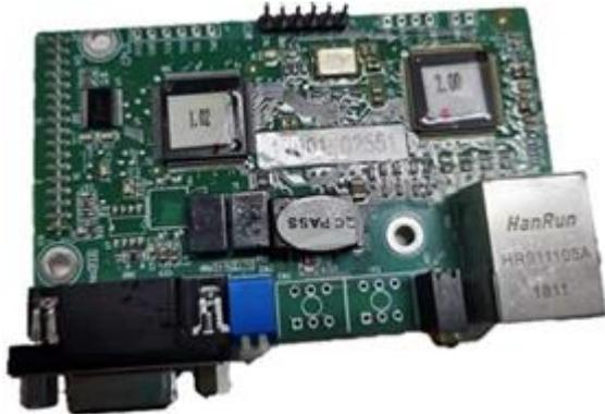
图 B-2 Ethernet+CANopen 通讯卡
